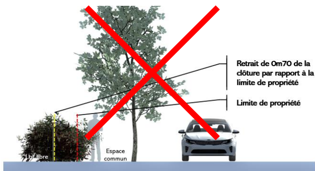
Figure 16 : Principe d'implantation du grillage et de la haie de type 2 bis en vue de profil
